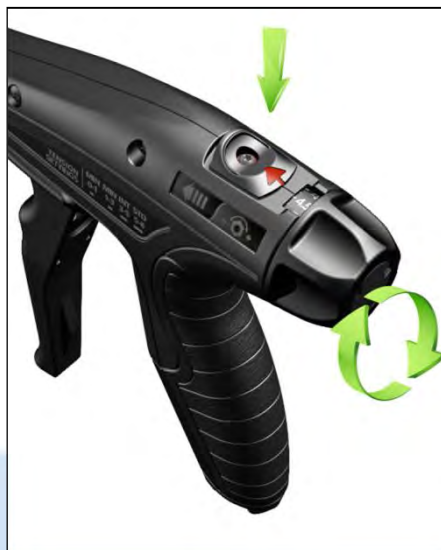
2. 当向前顶住拇指控制锁时，旋转拉力旋钮到所需的拉力设定。
